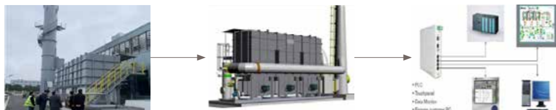
废气处理设备一站式处理、监测流程
